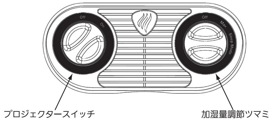
星空プロジェクタースイッチを入れるとプロジェクターランプが点灯して星空を映し出します。
