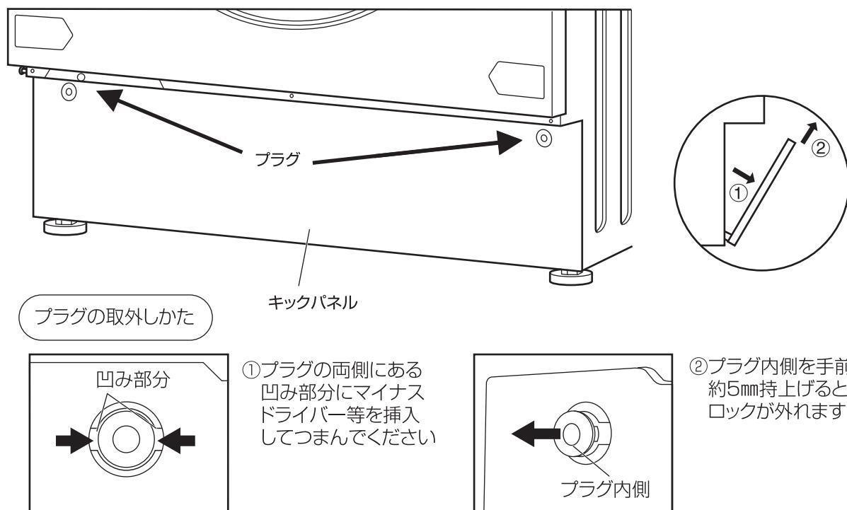
3)排水ホースAが熱い場合は、内部のお湯の温度が高いので冷めるまでお待ちください。浅い受け皿を床に置き、プラグBを外して中の水を受け皿に排水してください。中の水量が多い場合は、何回かに分けて排水してください。中の水を全て排水したら、プラグBを排水ホースAの先にしっかりと差し込んで戻してください。
