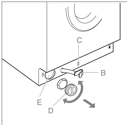
5)ポンプのカバーDを元に戻してください。排水ホースをCの穴にパチンと差し込んでください。キックパネルの下側を先に差し込んでから上側を押し込み、プラグを元のように取り付けてください。
